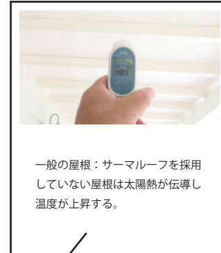
反射材施工していない一般的な屋根はお湯の温度より暑い外部ポーチ一般屋根部：48.9°C
