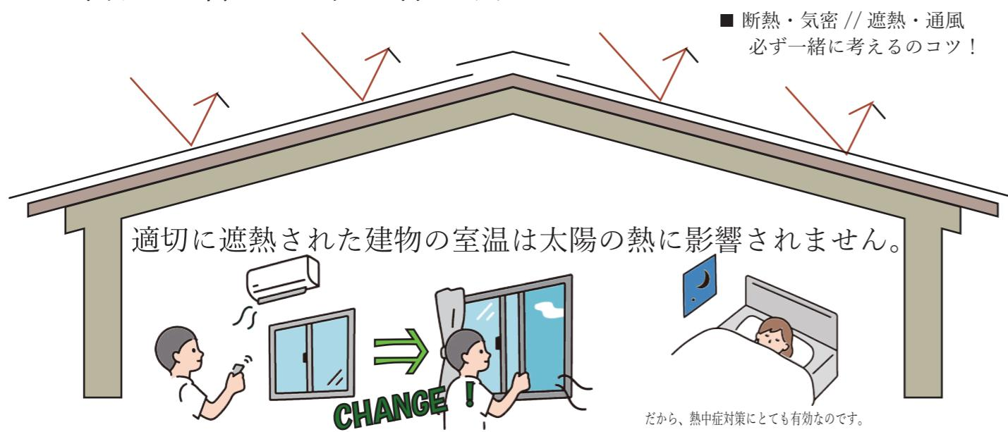
温暖な地域で適切に遮熱された建物に、適切な採風計画を施すと 通風だけで過す時間が 多くなります。また、晴天の猛暑日など天井や壁が熱を持つことないので冷房も短時間で設定温度まで下がり 過剰な運転がなくなる上に、冷やすのは外気温と快適温度の差分だけなのでとっても省エネ運転が可能となります。
